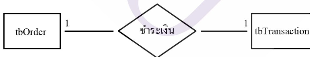
ภาพที่ 3.11 ความสัมพันธ์ระหว่างตาราง tbOrder และตาราง tbTransaction
