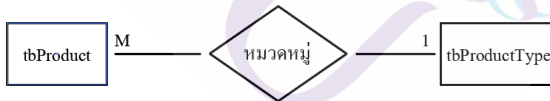
ภาพที่ 3.8 ความสัมพันธ์ระหว่างตาราง tbProduct และตาราง tbProductType
