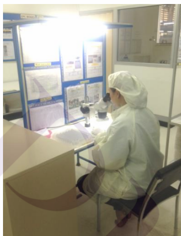
ภาพที่ 4.5 พนักงานสวมใส่ชุดสวมมือเพื่อป้องกันฝุ่นละอองติดที่ชิ้นงานในระหว่างขั้นตอนการตรวจสอบชิ้นงาน
