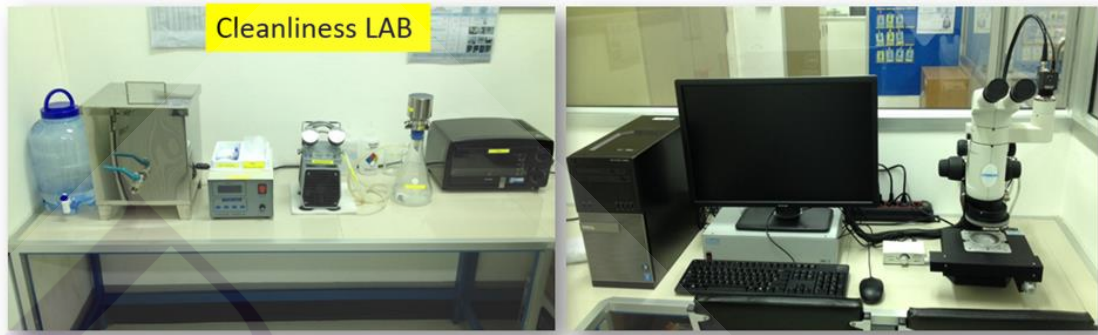
ภาพที่ 2.15 แสดงมาตรฐานการตรวจวัดและเครื่องมือตรวจวัดค่าความสะอาด (Automatic Cleanliness count)
