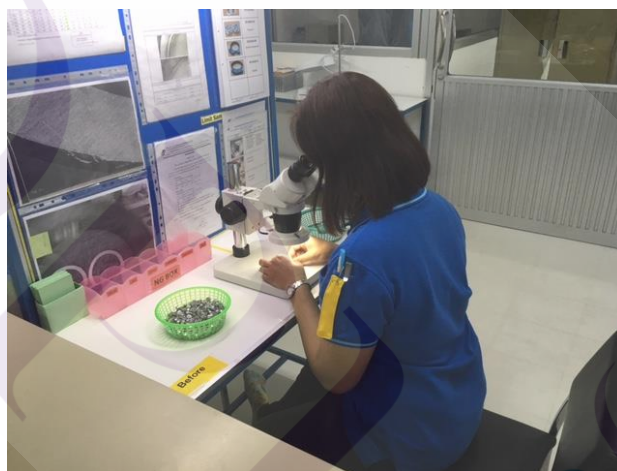
ภาพที่ 4.3 พนักงานยังไม่มีชุดสวมกสวมใส่เพื่อป้องกันฝุ่นละอองติดที่ชิ้นงานในระหว่างขั้นตอนการตรวจสอบชิ้นงาน
