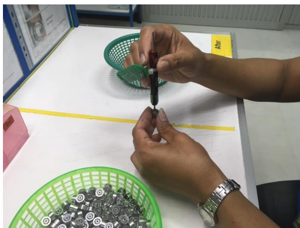
ภาพที่ 4.2 พนักงานไม่สวมถุงมือในระหว่างขั้นตอนการตรวจสอบชิ้นงาน
