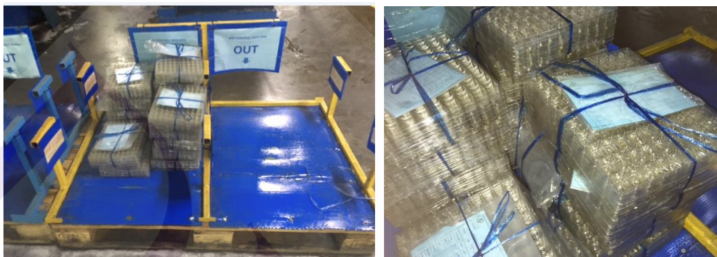
ภาพที่ 4.15 ใช้ถาดเก่าปนเปื้อนน้ำมันใส่ชิ้นงานจากกระบวนการ CNC ขาดการควบคุมและวิธีการที่เหมาะสม
