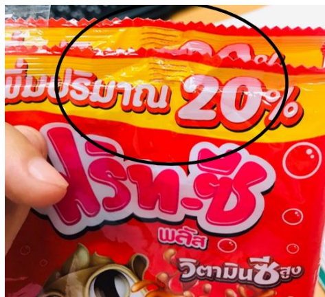
ภาพที่ 4.4 การซีลไม่ติดเนื่องจากใช้อุณหภูมิต่ำ
