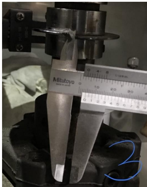
ภาพที่ 4.11 การตรวจเช็คจังหวะกระเช้าลำเรียงและแขนชัก
