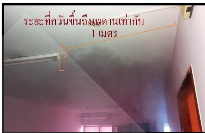
ภาพที่ 3.6 ระยะที่ควันลอยขึ้นถึงเพดานเท่ากับ 1 เมตร
