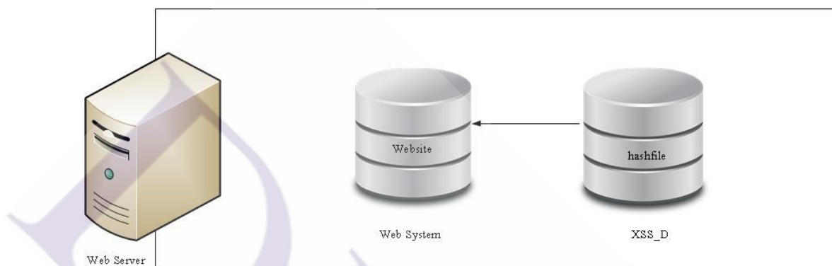
ภาพที่ 3.28 ฐานข้อมูล XSS_D เก็บ hash ไฟล์ข้อมูลของเว็บไซต์
