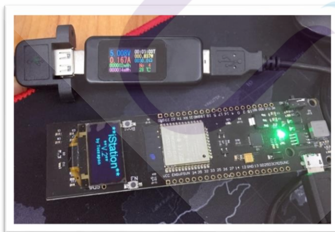
ภาพที่ 3.2 ภาพแสดงการทดสอบการใช้พลังงานของอุปกรณ์ BLE
