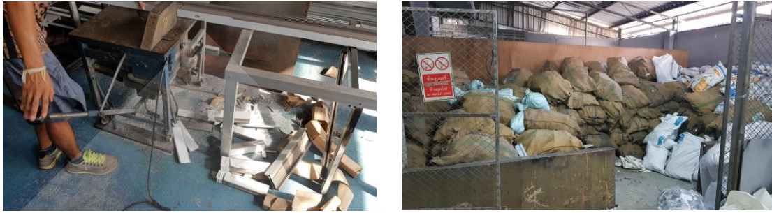
ภาพที่ 2.25 เศษตัดอลูมิเนียมในขั้นตอนการตัดอลูมิเนียมเส้นเป็นท่อน
