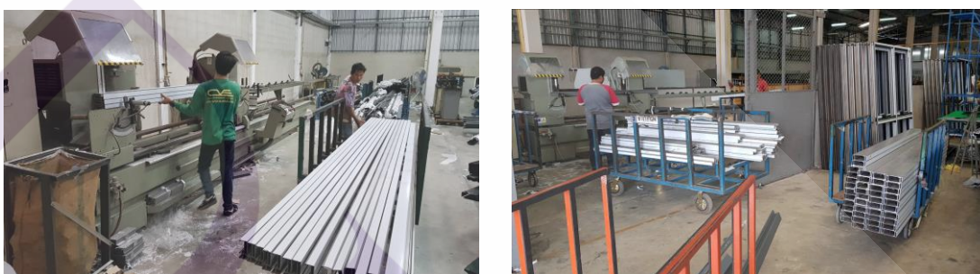
ภาพที่ 2.23 แสดงการตัดอลูมิเนียมเส้นเป็นท่อนด้วยเครื่องตัดที่ควบคุมด้วยคอมพิวเตอร์
