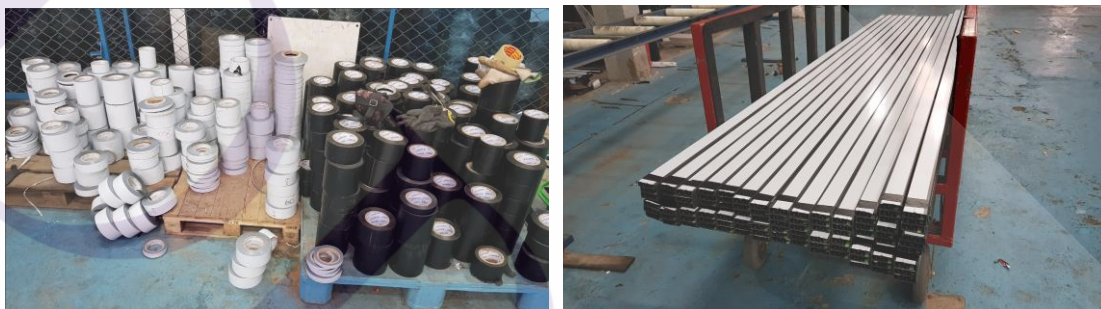
ภาพที่ 2.18 โพรเทคเส้นอลูมิเนียมเพื่อช่วยป้องกันรอยขีดข่วนบนผิวของชิ้นงาน
