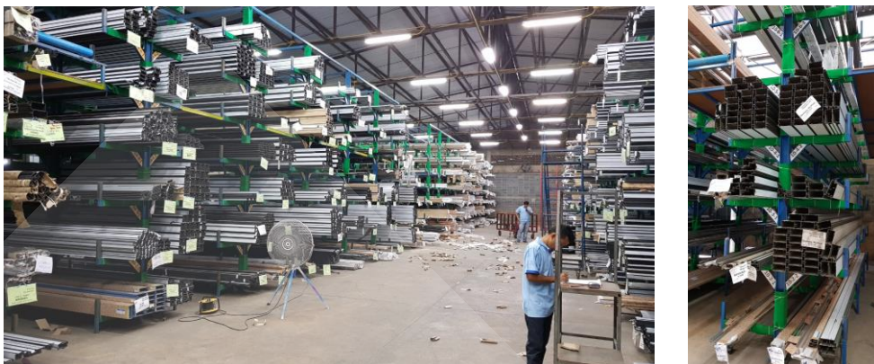
ภาพที่ 2.17 การเก็บข้อมูลนิยามเส้นบนชั้นวางพร้อมติด Stock Card เพื่อช่วยควบคุมการเบิกจ่าย
