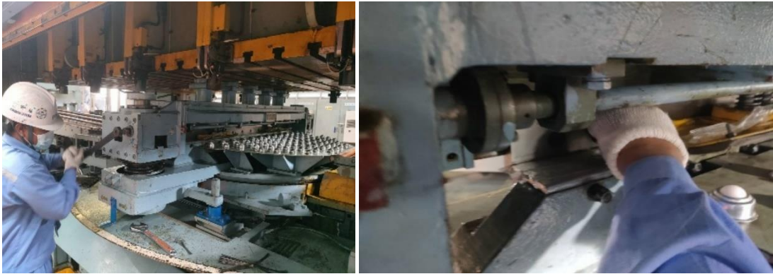
ภาพที่ 3.15 แสดงการปรับตั้งใบมีด Shear ของเครื่อง Blanking Line
