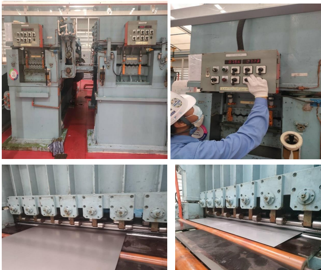
ภาพที่ 3.14 แสดงเครื่องรีดเหล็ก Leveller และ ชุดควบคุมระยะการตั้งค่าของเครื่องรีดเหล็ก
