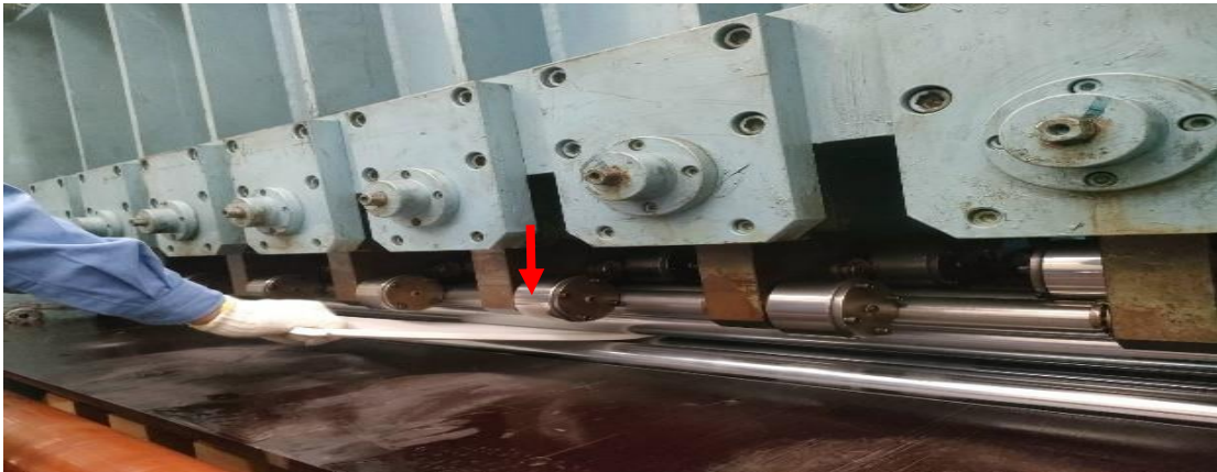
ภาพที่ 3.32 ภาพแสดงการล้าง โรล (Leveller Roll) ด้วยคน ที่แรงกดไม่ได้
