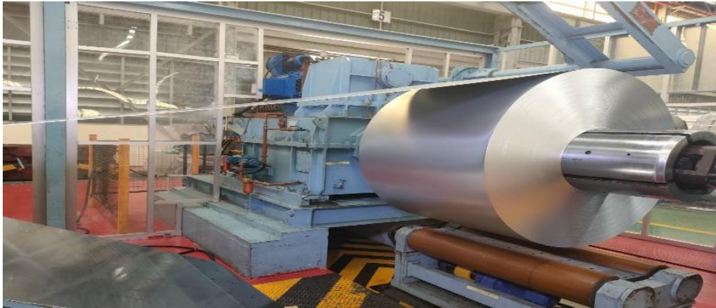
ภาพที่ 3.6 ภาพลักษณะผลิตภัณฑ์ในกระบวนการผลิต ส่วน Uncoiler
