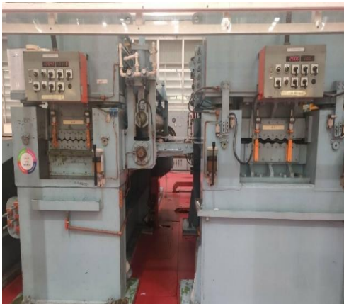
ภาพที่ 3.7 แสดงเครื่อง Leveller และการรีดเหล็ก
