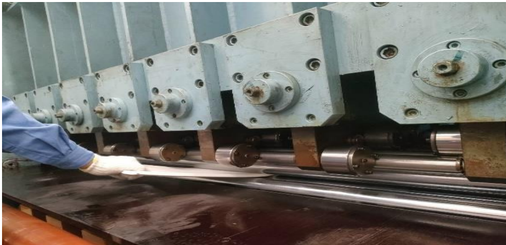
ภาพที่ 3.24 แสดงตัวอย่างการล้าง Leveller Roll ที่ยังตกค้างเศษฝุ่นบนผิวโรล
