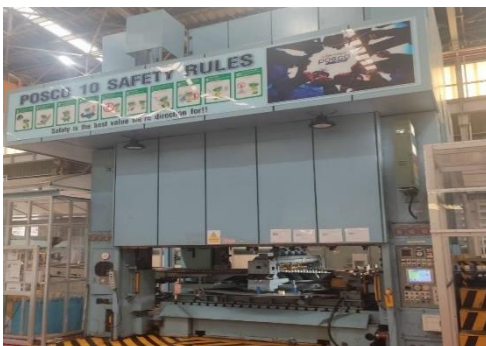
ภาพที่ 3.8 แสดงเครื่องตัดเหล็ก (shear) การแพคกิ่งแบบอัตโนมัติ (Piler Magnet)
