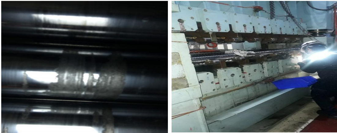
ภาพที่ 3.25 แสดงผิว Leveller Roll ที่การเคลือบผิวแบบฮาร์ดโครม หลุดออกจากเนื้อเหล็ก
