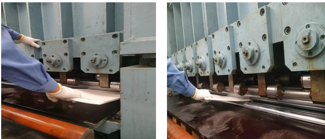
ภาพที่ 3.13 แสดงขั้นตอนการล้าง Leveller Roll แบบ Manual วิธีเดิม
