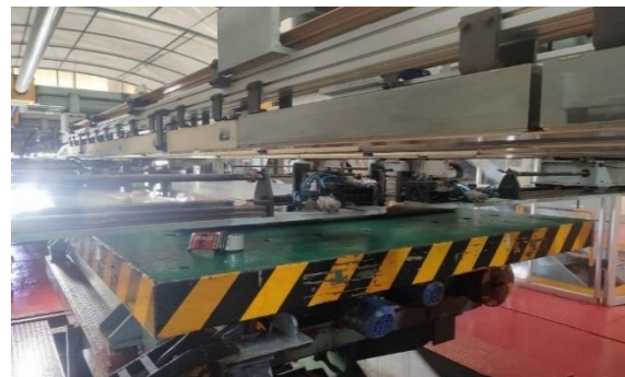
ภาพที่ 3.8 แสดงเครื่องตัดเหล็ก (shear) การแพคกิ่งแบบอัตโนมัติ (Piler Magnet)
