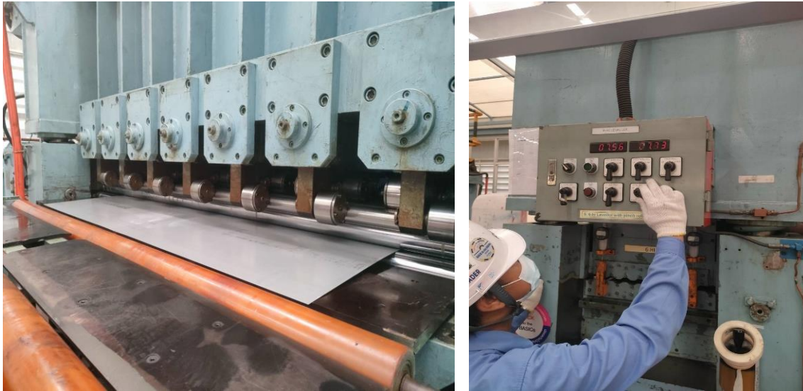
ภาพที่ 3.27 แสดงการปรับระยะการรีด ตามค่ามาตรฐาน ของขนาด Leveller
