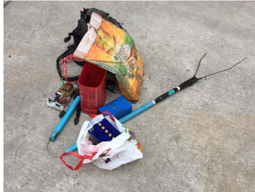
ภาพที่ 4.1 อุปกรณ์ที่ใช้ในการทำประมงด้วยกระแสไฟฟ้า
