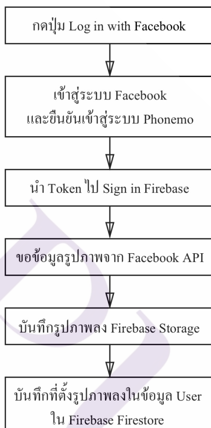
ภาพที่ 3.8 แผนภาพแสดงกระบวนการเข้าสู่ระบบผ่าน Facebook ของแอปพลิเคชัน Phonemo
