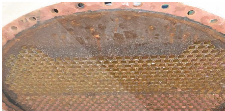
ภาพที่ 3.18 สภาพท่อคอนเดนเซอร์อุดตันจากคราบตะกรัน
