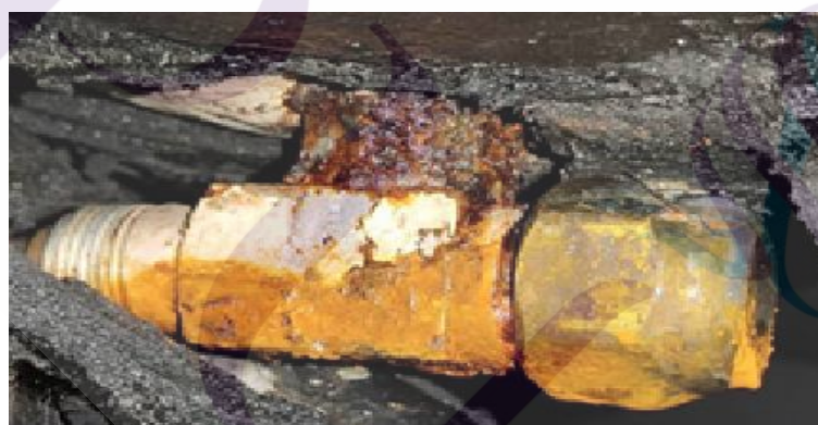
ภาพที่ 3.17 สภาพวาล์วที่เสียหายเนื่องจากฉนวนเครื่องทำความเย็นชำรุด
