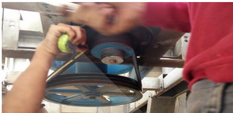
ภาพที่ 4.3 การตรวจเช็คปรับตั้งความตึงสายพาน
