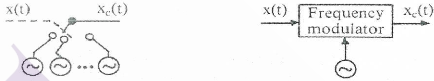
รูปที่ 2.53 การมอดูเลตสัญญาณดิจิทัล โดยการเปลี่ยนความถี่ของคลื่นพาห์
