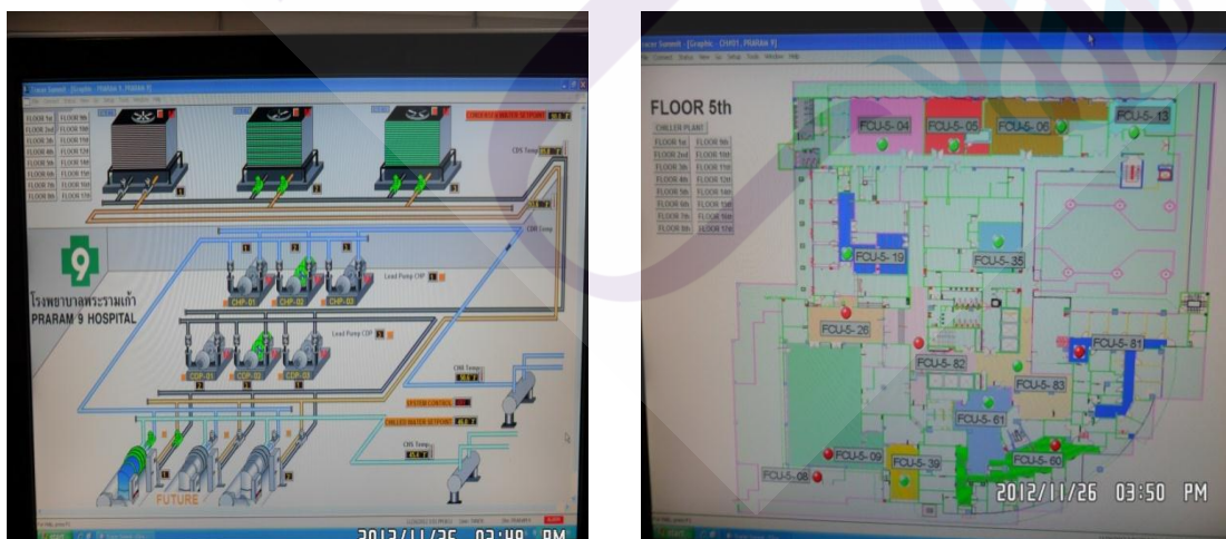
รูปที่ 3.12 ระบบควบคุมระบบปรับอากาศอัตโนมัติ SUMMIT TRANE
