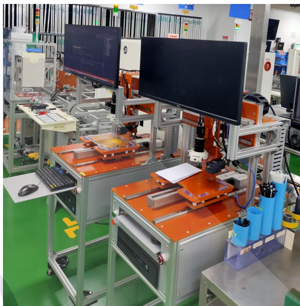
ภาพที่ 1.2 เครื่องจักรที่ออกแบบและประกอบมาใช้ในระบบการตรวจสอบชิ้นงาน
