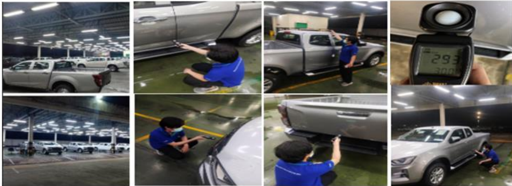
ภาพที่ 4.4 ทดสอบค่าความส่องสว่างของแสง Test Lux
