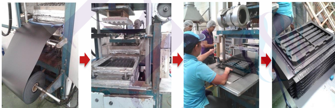
ภาพที่ 1.2 ภาพแสดงการทำงานของเครื่องขึ้นรูปพลาสติกด้วยระบบสูญญากาศ
