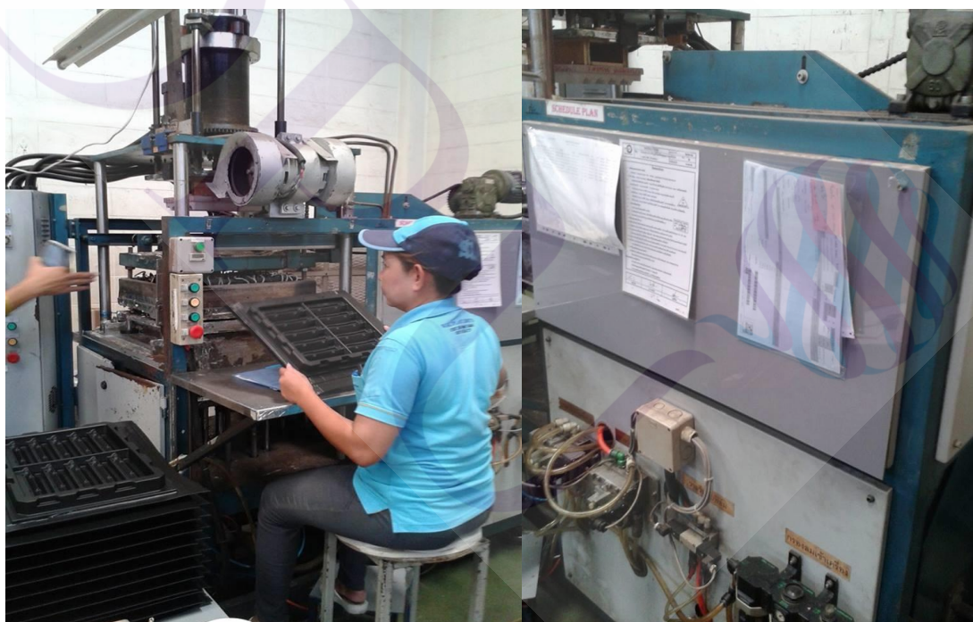
ภาพที่ 3.4 ตัวอย่างเครื่องขึ้นรูปพลาสติก แบบสูญญากาศ
