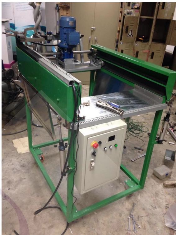
รูปที่ 3.20 การสร้างอุปกรณ์ติดตั้งเสริมชุดแขนกล
