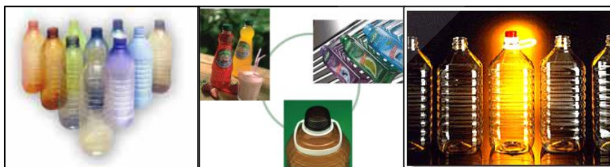
ภาพที่ 2.4 ตัวอย่างผลิตภัณฑ์ขวดพลาสติกที่ขึ้นรูปด้วยการ Stretch Blow Molding
