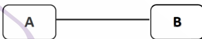
ภาพที่ 2.13 ความสัมพันธ์หนึ่งต่อหนึ่ง หรือแบบ 1:1
