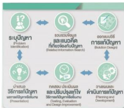
ภาพที่ 2.2 กระบวนการออกแบบเชิงวิศวกรรม (Engineering Design Process)
