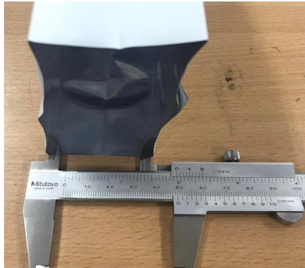
1 ขนาดความกว้างของช่องกาแฟ เท่ากับ 49 มม.
