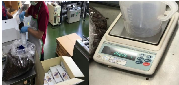
ภาพที่ 3.6 ลักษณะการบรรจุเมล็ดกาแฟขนาด 250 กรัม
