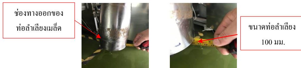
ภาพที่ 3.19 แสดงถึงขั้นตอนการวัดขนาดท่อลำเลียงเมล็ดกาแฟของเครื่องชงน้ำหนักแบบอัตโนมัติ
