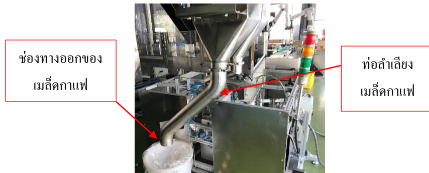
ภาพที่ 3.18 แสดงถึงช่องทางออกของเมล็ดกาแฟจากเครื่องชงน้ำหนักแบบอัตโนมัติ
