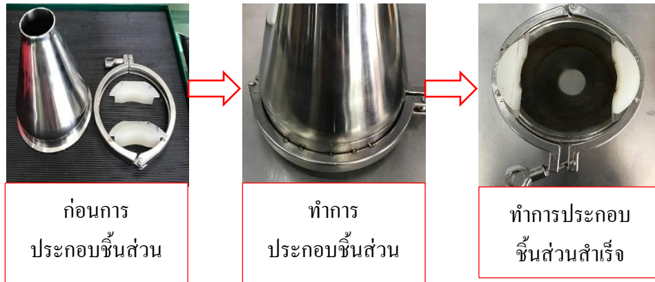
ภาพที่ 3.23 แสดงถึงการประกอบอุปกรณ์รวมกันเป็นชุดท่อกรวยบรรจุเมล็ดกาแฟ
