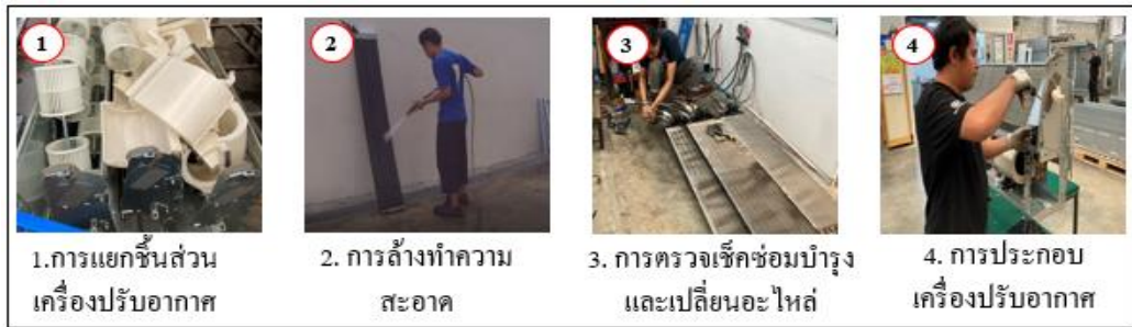
ภาพที่ 1.1 กระบวนการ Refurbish เครื่องปรับอากาศ
