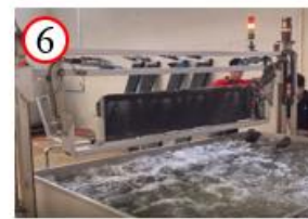
6. รอเครื่องล้างคอยล์เย็น ทำงานเสร็จ
