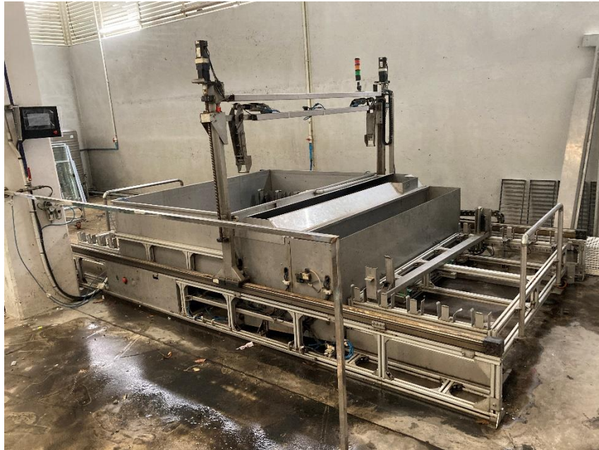
ภาพที่ 1 เครื่องล้างคอยล์เย็นแบบอัตโนมัติ
