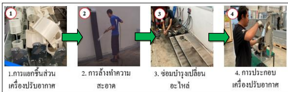
ภาพที่ 3.3 กระบวนการปรับปรุงประสิทธิภาพเครื่องปรับอากาศ
