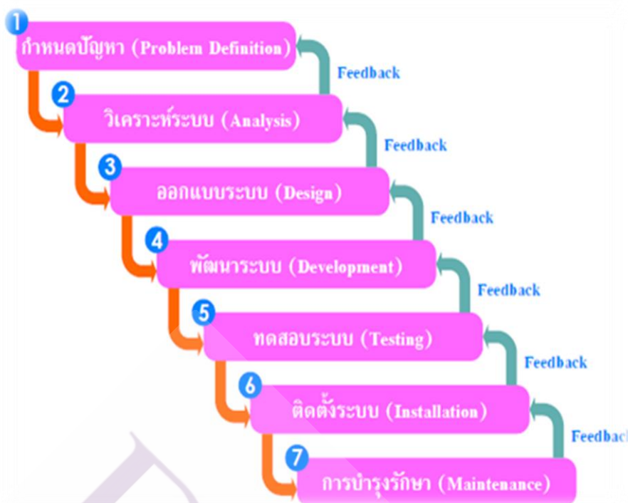
ภาพที่ 2.1 วงจรการพัฒนาารบบ (System Development Life Cycle)
