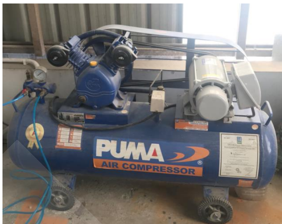
ภาพที่ 2.1 แสดงลักษณะเครื่องอัดอากาศแบบลูกสูบ
