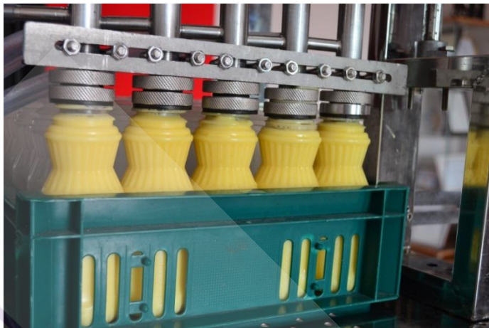
ภาพที่ 3.14 หัวบรรจุสามารถปรับหัวให้เข้ากับระยะของขวดพลาสติก
