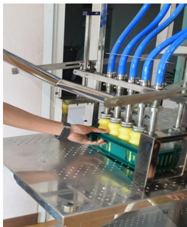
ภาพที่ 4.9 ลักษณะการใช้งานตัวเครื่องบรรจุน้ำนมข้าวโพด
