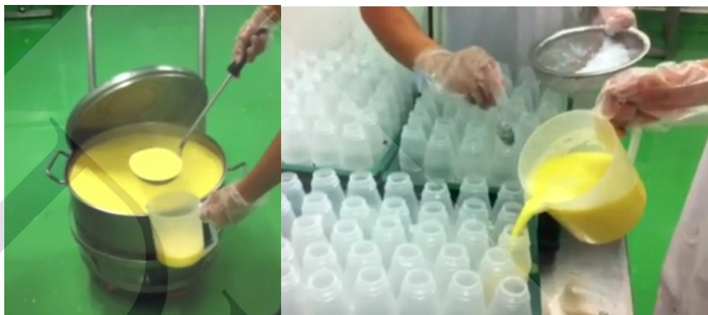
ภาพที่ 3.10 กระบวนการบรรจุก่อนการปรับปรุง
