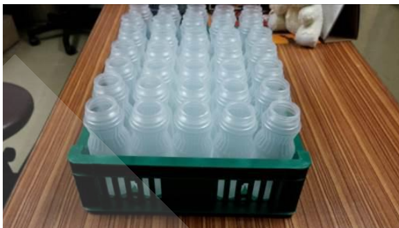
ภาพที่ 4.2 การจัดเรียงขวดพลาสติกลงในตะกร้าพลาสติกก่อนการบรรจุ
