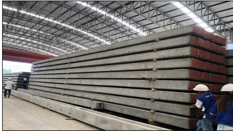
ภาพที่ 3.15 การจัดเก็บเสาเข็มเข้าสต็อก จากนั้นวางไม้หมอน ไม้หมอนต้องอยู่ตรงกัน
