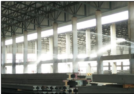
ภาพที่ 4.4 น้ำบ่มคอนกรีต การบ่มเส้มน้คอนกรีตอัดแรงทำให้ปฏิกิริยาไฮเดรชันของปูนซีเมนต์
