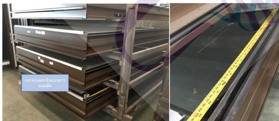
ภาพที่ 4.13 ภาพแสดงข้อผิดพลาดที่เกิดจากการแพ็คและเคลื่อนย้าย
