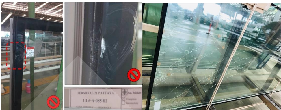
ภาพที่ 4.7 กระจกแตกเกิดจากกระบวนการผลิตแผงผนังกระจก (สถานีประกอบกระจก)
