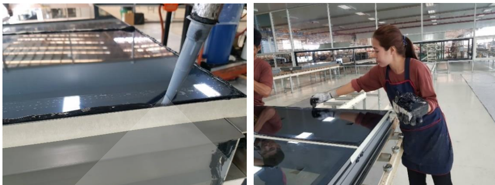
ภาพที่ 4.12 การยิงวัสดุยาแนวที่ใหญ่เกินไปทำให้เกิดความสูญเสีย
