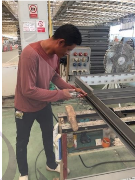
ภาพที่ 3.7 แสดงถึงการยิงซีลิกอนบริเวณรอยต่อและกอบอลูมิเนียมให้เป็น โครงสำเร็จ
