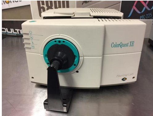
ภาพที่ 6 เครื่องวัดสีแบบตั้งโต๊ะ (Tabletop Spectrophotometer)
