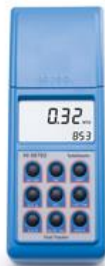
ภาพที่ 7 เครื่องวัดค่าความขุ่นแบบพกพา HANNA รุ่น HI-98703
