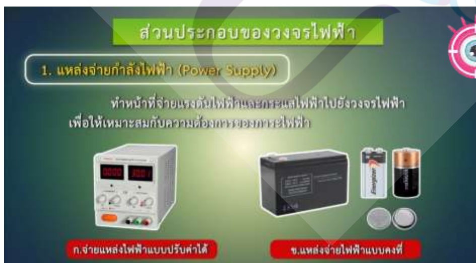
ภาพที่ 2 แหล่งจ่ายกำลังไฟฟ้า
