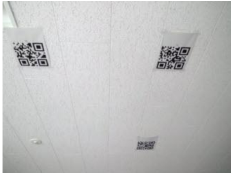
ภาพที่ 2.3 ป้าย QR Code บนเพดาน เพื่อให้นำทางให้กับโรบอท
