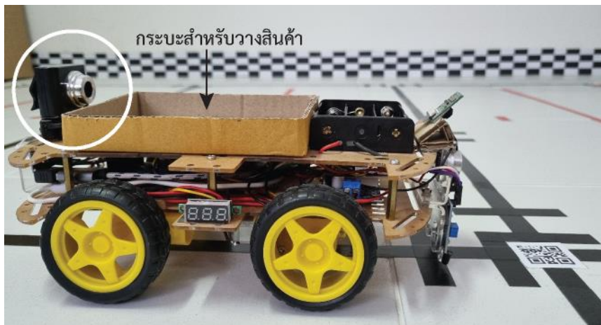
ภาพที่ 3.26 การจัดวางกล้องเว็บแคมที่ส่วนท้ายของโรบอท
