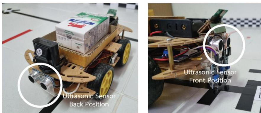
ภาพที่ 3.30 ตำแหน่งที่ติดตั้งเซ็นเซอร์อัลตราโซนิกส์ที่ด้านหน้าและด้านหลังของโรบอท
