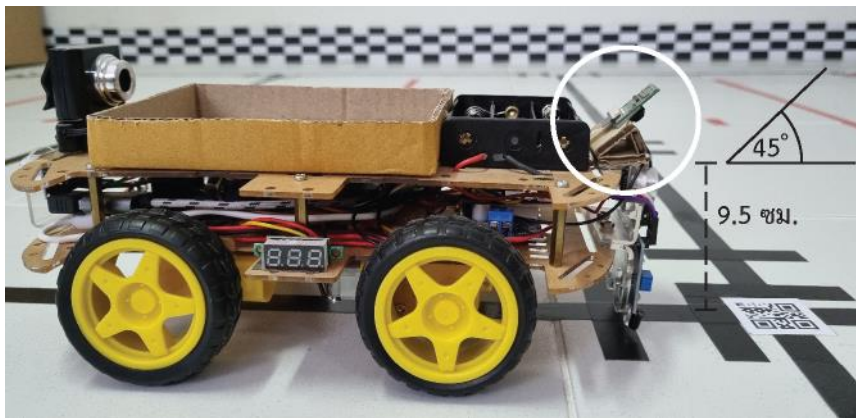
ภาพที่ 3.22 การจัดวางกล้องเว็บแคมที่ส่วนหน้าของโรบอท
