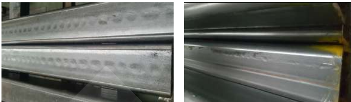
ภาพที่ 3.24 ลักษณะรอยโรลมาร์คที่ผิวเหล็กส่งผลต่อกระบวนการทำสี
