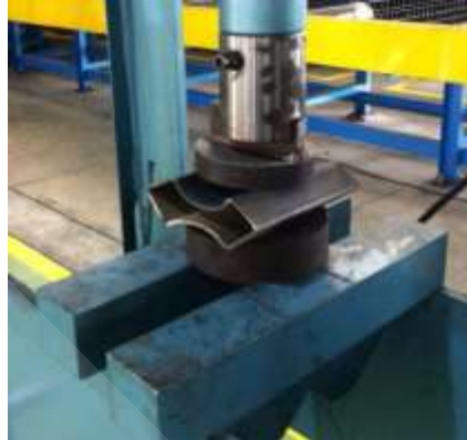
ภาพที่ 3.15 การทดสอบ Cold Flattening ของงานท่อเหลี่ยม
