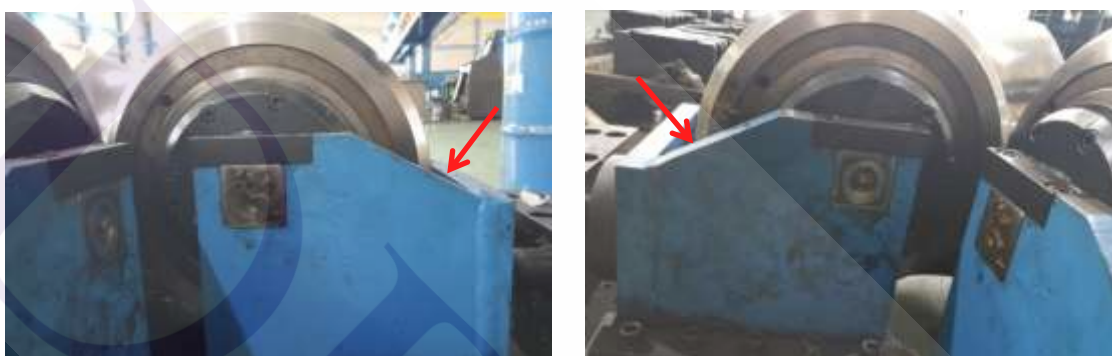
ภาพที่ 3.31 ภาพแสดงการวิเคราะห์ตำแหน่งเพื่อติดตั้งชุดทำความสะอาดที่บริเวณลูกรีด
