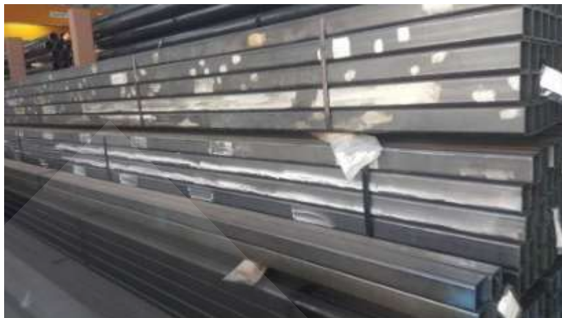
ภาพที่ 3.26 รูปแบบการเจียรแต่งแก้ไขผิวงานท่อเพื่อให้มีลักษณะผิวเรียบ
