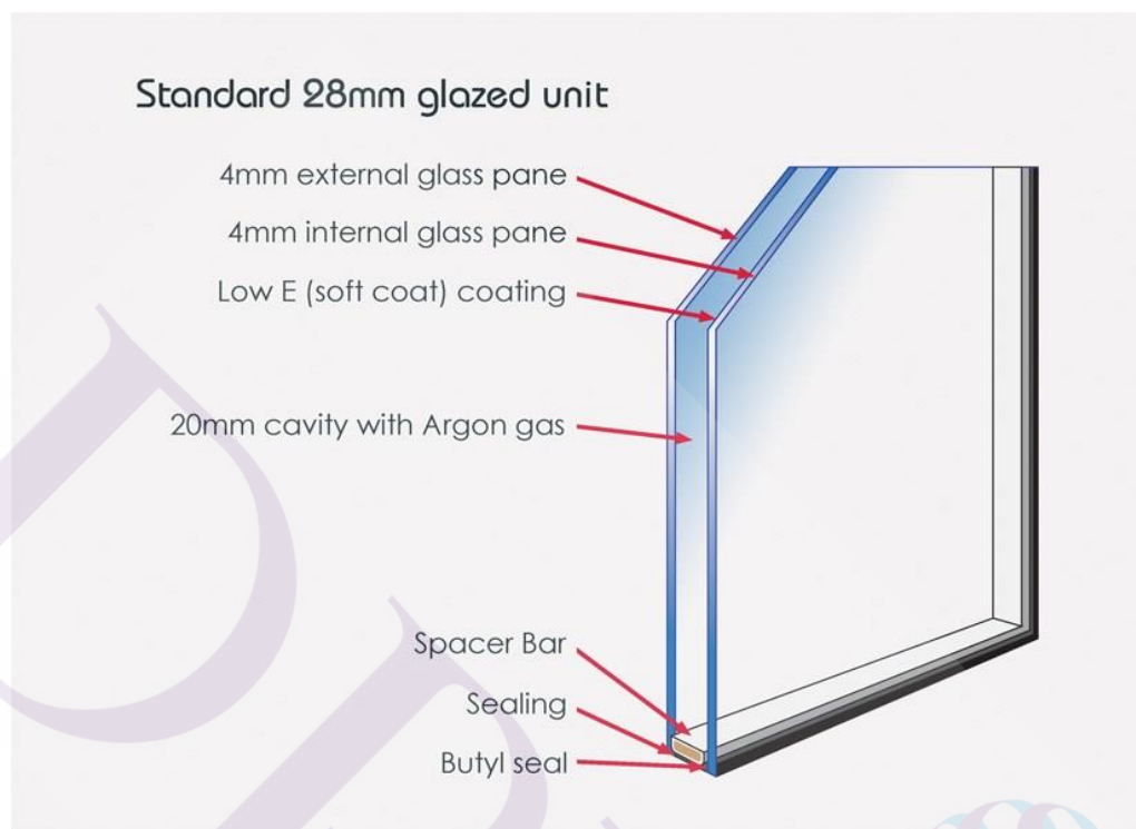
ภาพที่ 2.12 แสดงกระจกกันความร้อนชนิดใช้ก๊าซเป็นฉนวนตรงกลาง
