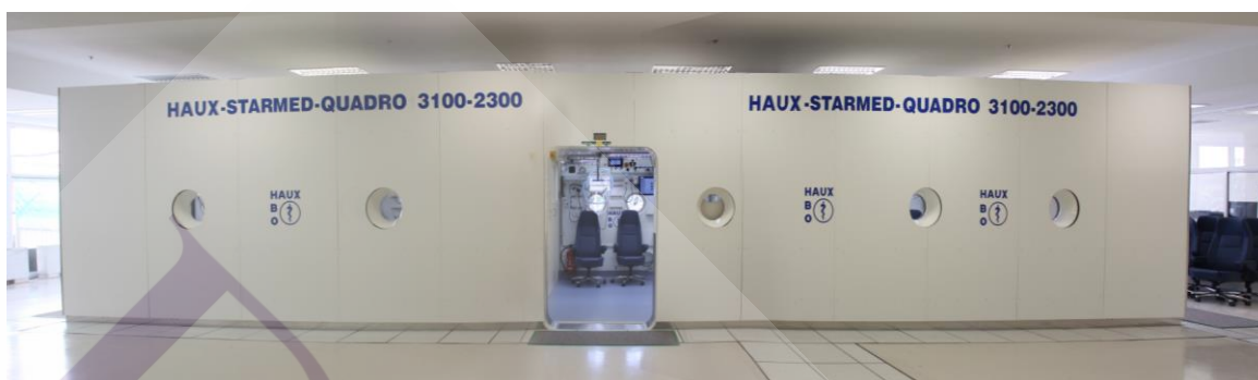
ภาพที่ 3.2 ห้องปรับแรงดันบรรยากาศสูงชนิด Multiplace ตราอักษร HAUX-LIFE-SUPPORT
