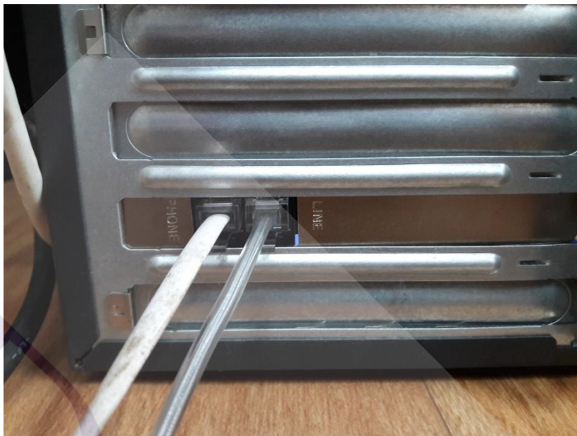
ภาพที่ 3.15 ภาพการต่อสายสัญญาณโทรศัพท์กับ Asterisk card X100P
