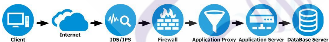
ภาพที่ 3.3 โครงสร้างระบบรักษาความปลอดภัยที่มี Firewall, IDS/IPS และ Application Proxy
