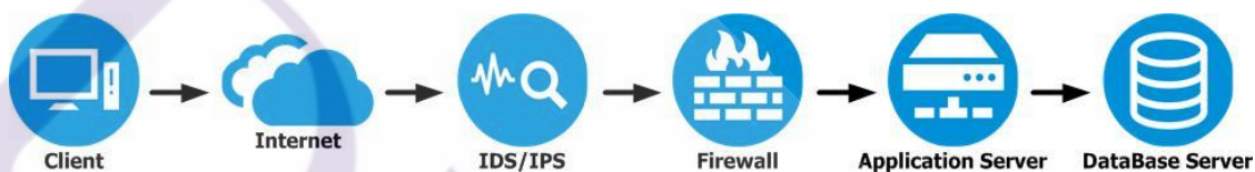
ภาพที่ 3.2 โครงสร้างระบบรักษาความปลอดภัยที่มี Firewall และ IDS/IPS
