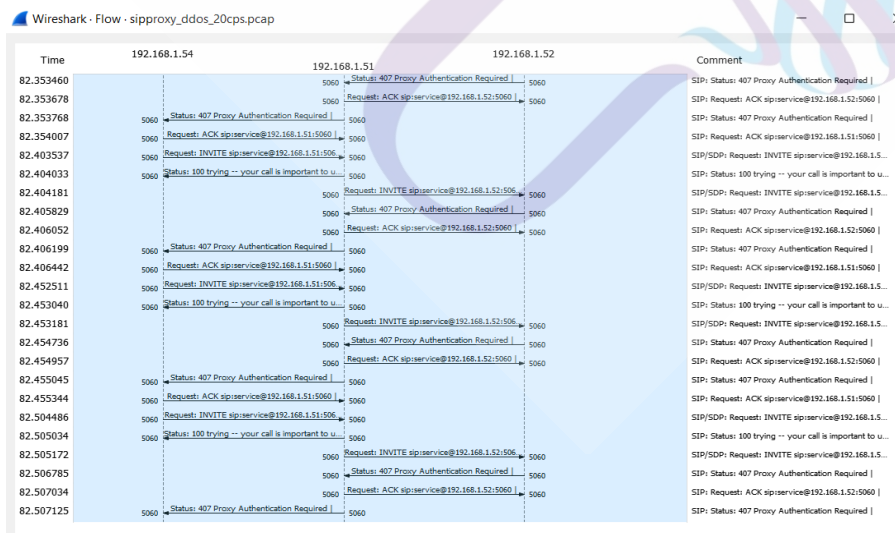
ภาพที่ 4.21 แสดงข้อมูลการเชื่อมต่อสัญญาณระหว่างโปรแกรมทดสอบการโจมตีกับ IPPBX SERVER และ IPPBX SERVER แบบที่ 1 ครั้งที่ 2
