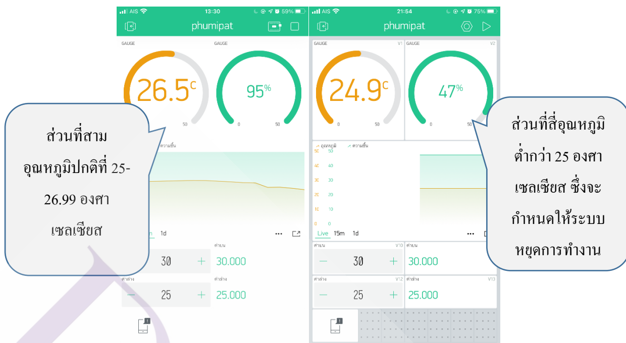
ภาพที่ 4.5 รายงานผลแสดงอุณหภูมิและความชื้นภายในอาคาร เพื่อเปรียบเทียบและยืนยันผ่านสมาร์ตโฟนโดยใช้ MQTT : Blynk Application
