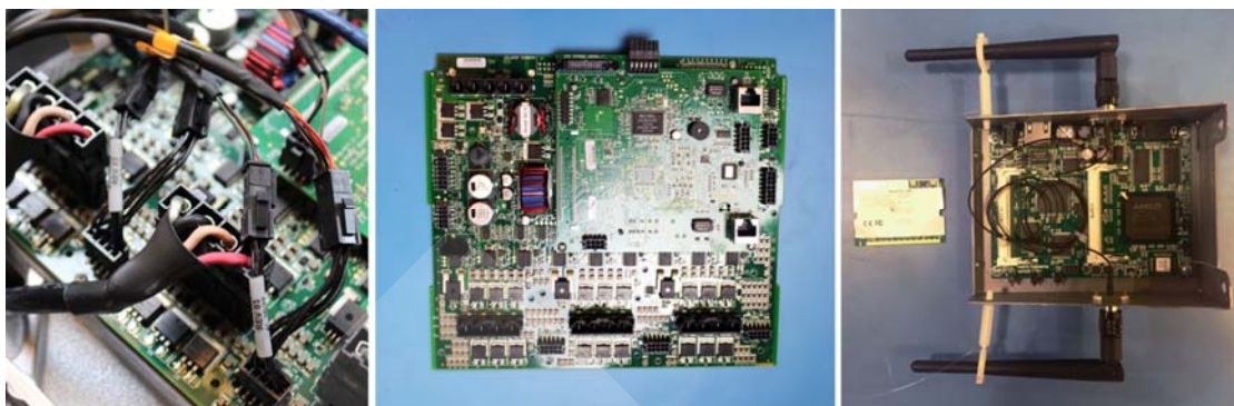
ภาพที่ 2.16 วงจรควบคุมมอเตอร์ และชุดสื่อสารไร้สายของหุ่นยนต์ Kiva
