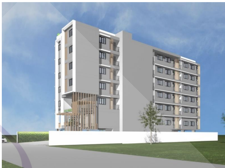
ภาพที่ 3.3 ภาพ Perspective (1) แสดงภาพเสมือนจริงด้านซ้ายของอาคาร ทำให้เห็นลักษณะหน้าต่าง ห้องพักและระเบียง และ โทนสีที่เลือกใช้ของอาคาร
