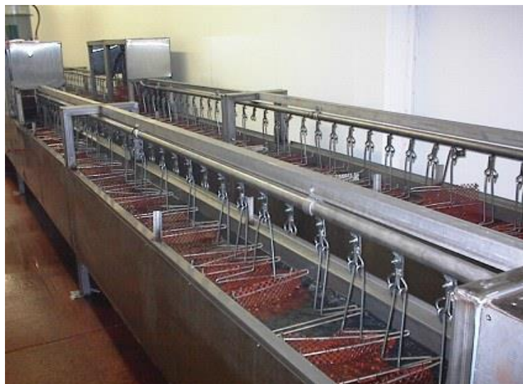
ภาพที่ 2.2 ระบบพาสเจอร์ไรซ์ในภาชนะปิดผนึกสนิท (in-container pasteurization)
