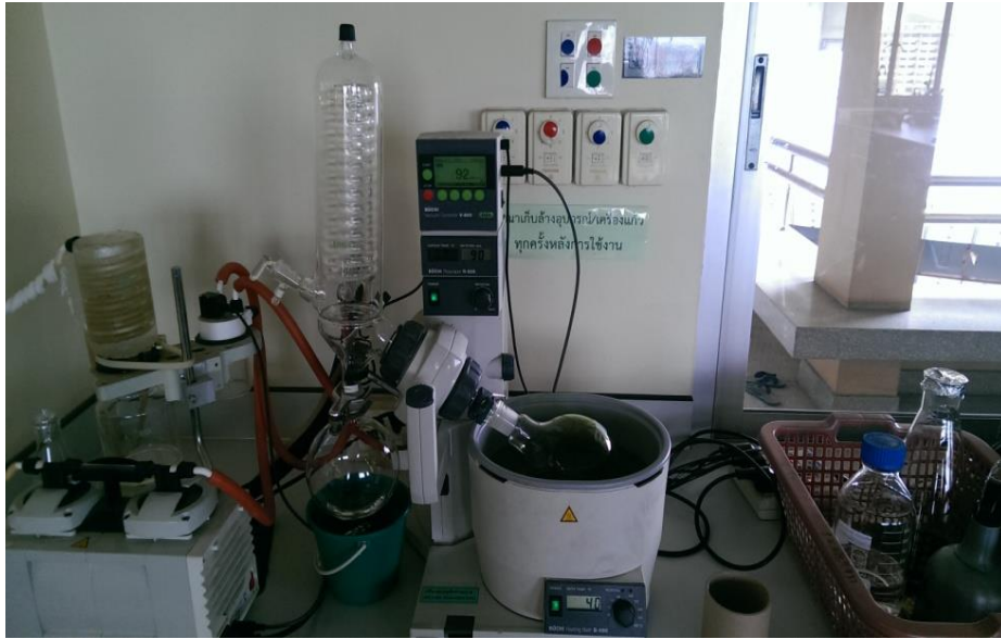
รูปที่ ข-3 Rotary evaporator (R-205, Buchi, England)
