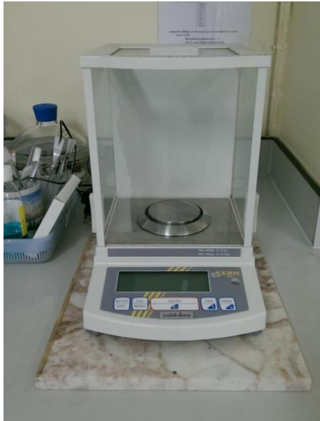
รูปที่ ข-1 เครื่องชั่ง 4 ตำแหน่ง (XT 120A, Precisa instruments Ltd, Switzerland)
