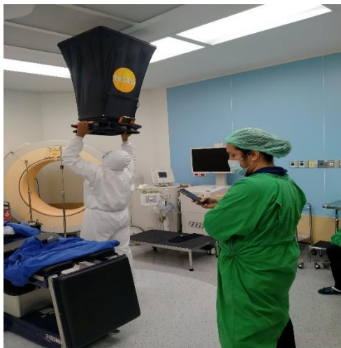
ภาพที่ 4.14 การตรวจวัดอัตราการไหลของอากาศ (Air Flow) ภายใน ห้องผ่าตัด OR3 โดย เครื่องตรวจสอบระบบระบายอากาศ (Modular Air Balancing Tool)
