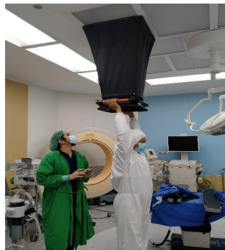
ภาพที่ 4.14 การตรวจวัดอัตราการไหลของอากาศ (Air Flow) ภายใน ห้องผ่าตัด OR3 โดย เครื่องตรวจสอบระบบระบายอากาศ (Modular Air Balancing Tool)
