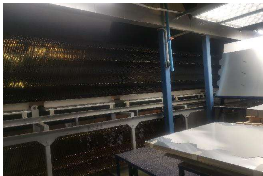
ภาพที่ 3.11 เครื่องกลับเหล็ก Pile Turner
