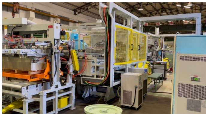
ภาพที่ 3.15 เครื่องจักรสำหรับผลิตกระป๋อง
