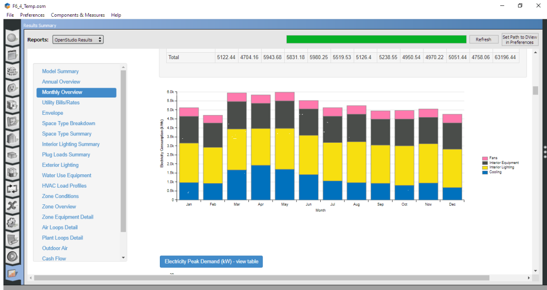
ภาพที่ ข. 13 ตัวอย่างรายละเอียดการแสดงผลส่วนการใช้พลังงานของอาคาร 6 ชั้นที่ 6 โดย โปรแกรม OpenStudio version 3.3.0
