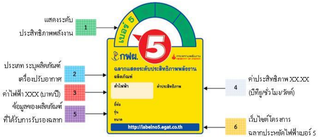
ภาพที่ 2.15 รายละเอียดฉลากแสดงระดับประสิทธิภาพพลังงาน (ขนาดจริงกว้าง 72 มม. สูง 89 มม.)
