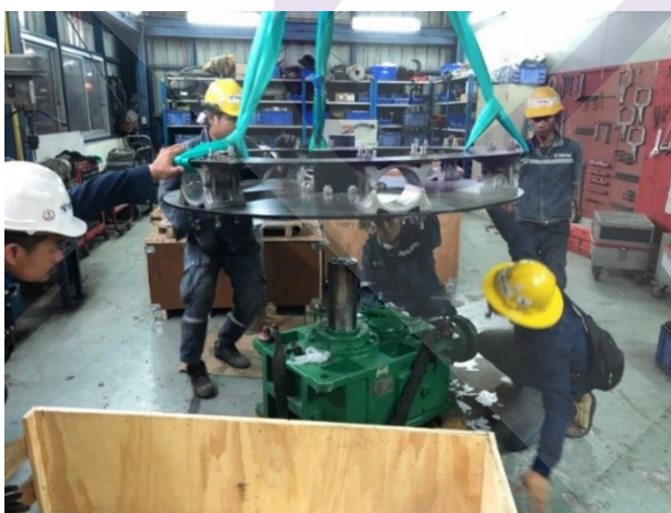
ภาพที่ 4.27 แสดงการทดสอบประกอบชุดคุมกลางกับ ชุด shaft Gearbox พบปัญหาไม่
