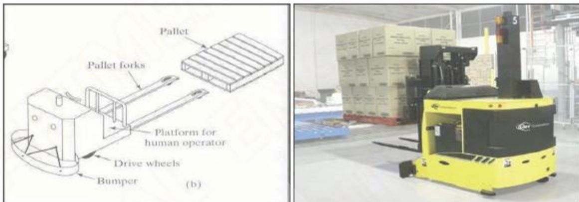
ภาพที่ 2.9 ตัวอย่างพาหนะขนส่งเคลื่อนที่อัตโนมัติแบบ Pallet Truck [10]
