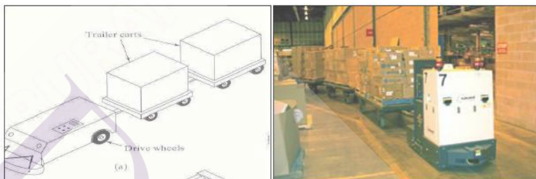
ภาพที่ 2.8 ตัวอย่างพาหนะขนส่งเคลื่อนที่อัตโนมัติแบบ Driver train [10]
