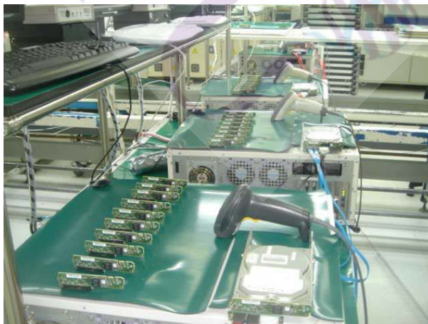
ภาพที่ 3.14 ลักษณะการจัดเรียงบอร์ด ณ สถานีเครื่องทดสอบการทำงานจริง
