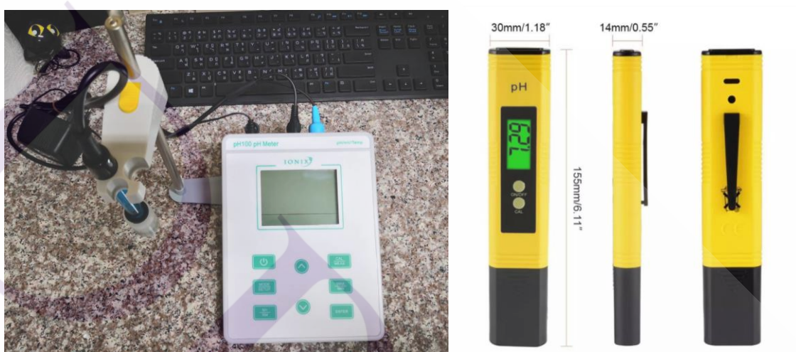
ภาพที่ 3.2 pH meter แบบตั้งโต๊ะ และ pH meter แบบพกพา ที่ใช้ในการศึกษา
