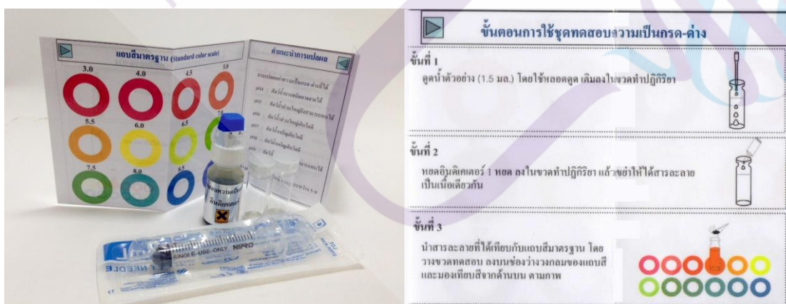
ภาพที่ 2.6 สารละลายยูนิเวอร์แซลอินดิเคเตอร์
