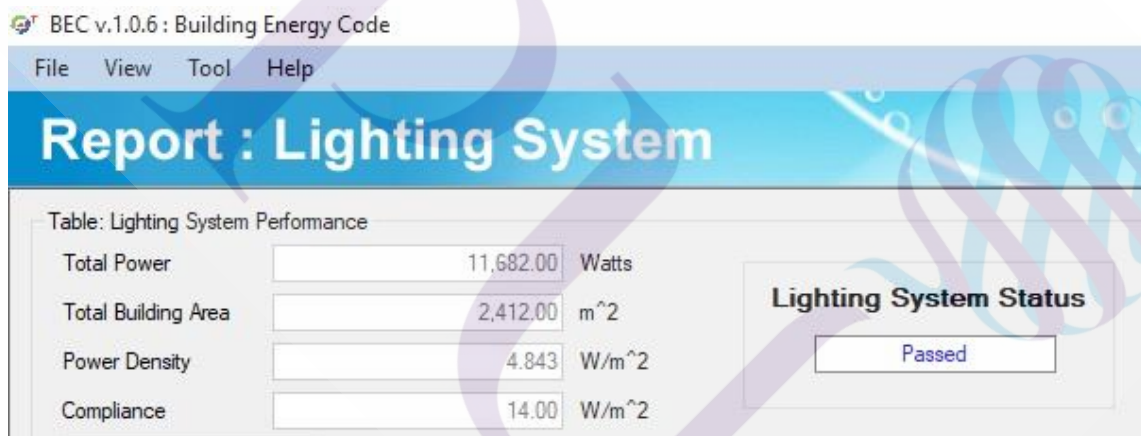
ภาพที่ 4.34 ค่า LPD ของระบบแสงสว่างหลังปรับปรุง
