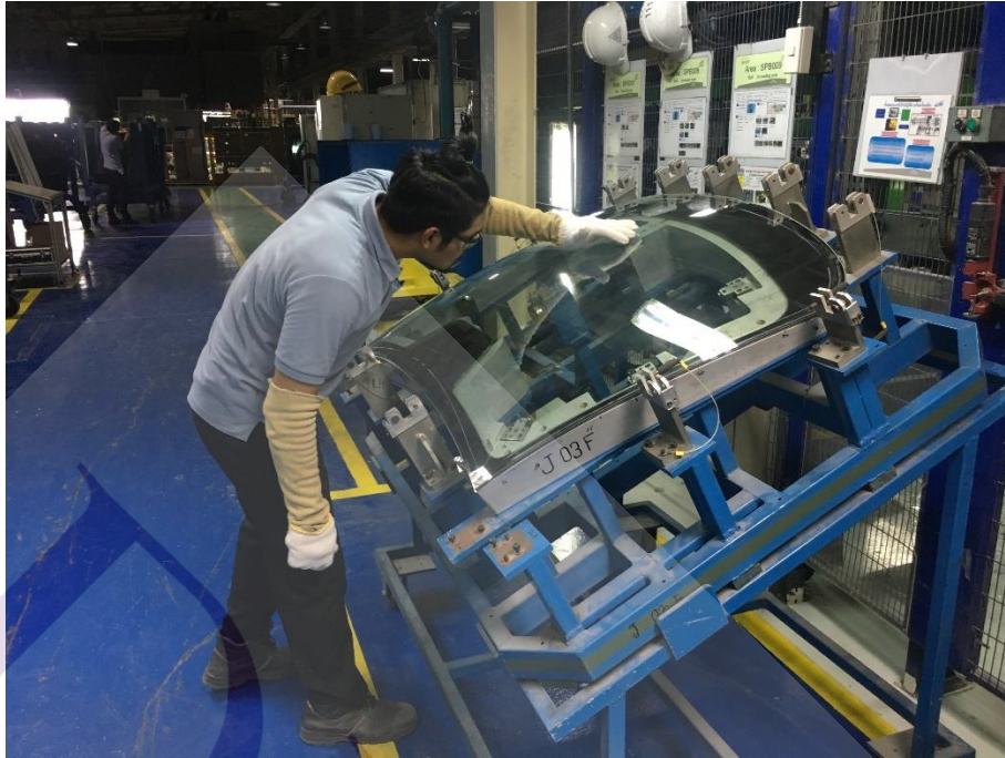
ภาพที่ 5 checking fixture สำหรับเช็คความโค้งของกระจก
