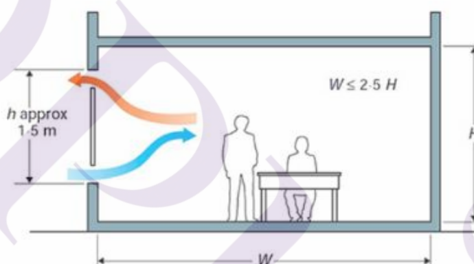
ภาพที่ 2.3 รูปแบบการไหลเวียนของกระแสลม แบบการระบายอากาศด้านเดียว จาก Automatic Natural ventilation. Andrew Dyke. 2014
