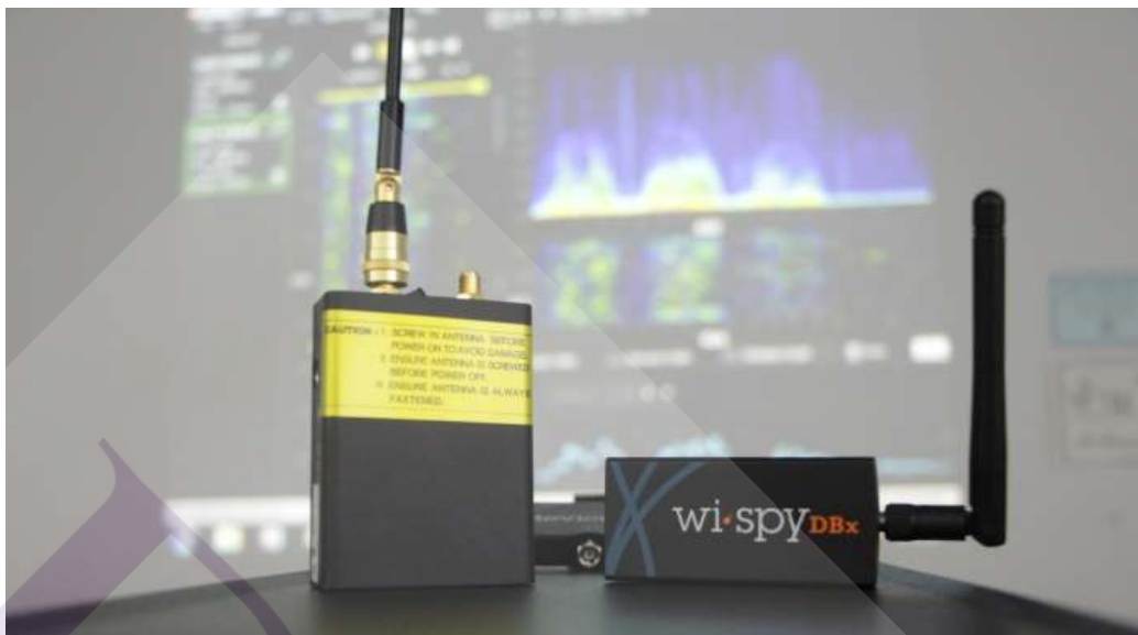
ภาพที่ 4.5 อุปกรณ์ Jammer หรือ เครื่องรบกวน/ตัดสัญญาณ (มหาวิทยาลัยเทคโนโลยีมหานคร, ออนไลน์)
