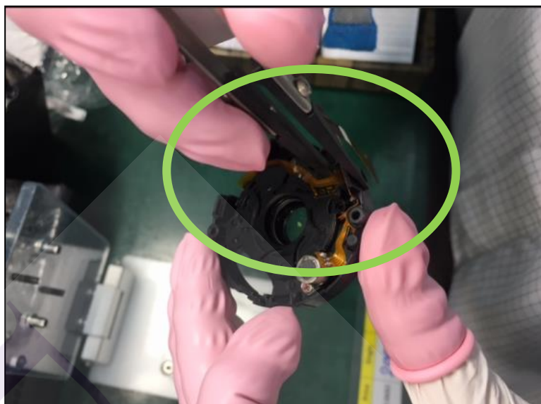
ภาพที่ 4.49 ตัวอย่างการใช้ Tweezers ESD ในกระบวนการตรวจสอบและซ่อมแซม (หลังปรับปรุง)
