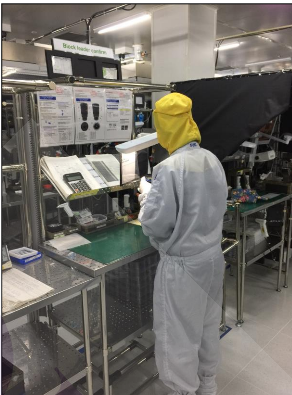
ภาพที่ 4.42 หัวหน้างานทำการตรวจสอบเลนส์ถ่ายภาพก่อนส่งไปยังฝ่ายประกันคุณภาพ
