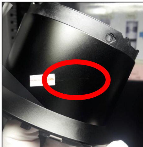
ภาพที่ 4.5 แสดงตัวอย่างลักษณะข้อบกพร่องพื้นผิวของวัสดุภายนอกมีรอยขีดข่วน
